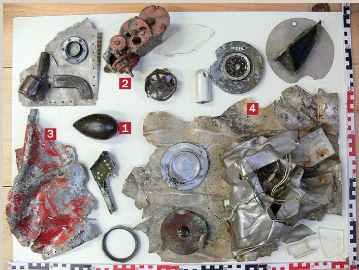
Ergebnisse der ersten Grabung 2008, durchgeführt vom Autor. Zu sehen sind unter anderem 1. Schleppantennengewicht, 2. Zahnradmechanik von der Radaranlage, 3. Teil des Ruders mit Originalfarbe, 4. Flügelblech
