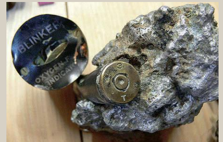
Ein Aluminiumfragment aus dem Wrack, das mit einer cal.50-Hülse verschmolzen ist
