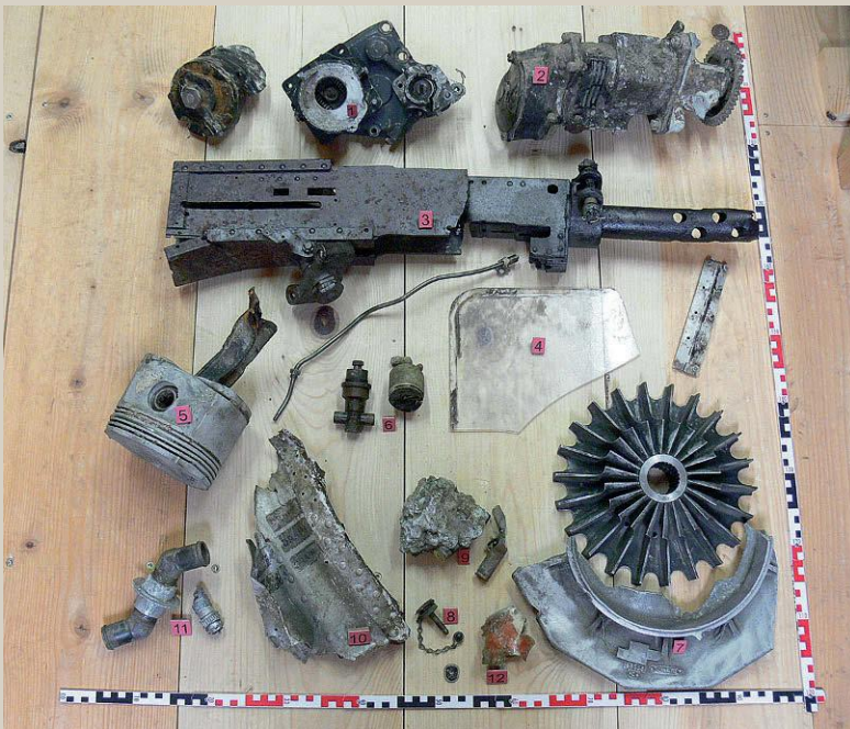
Wrackteile der abgeschossenen B-17, darunter ein Kompressorlaufwerk, ein Teil der Tragfläche, ein Browning-MG und Kolben des Wright-Cyclone-Motors
