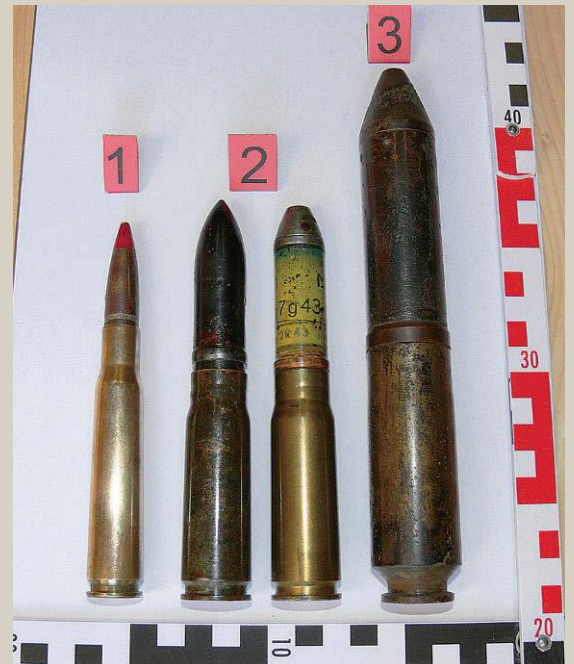
1. US-cal.50, 2. deutsche 2-cm-Panzerspreng- und 2-cm-Minengranate, 3. 3-cm-Minengranate
